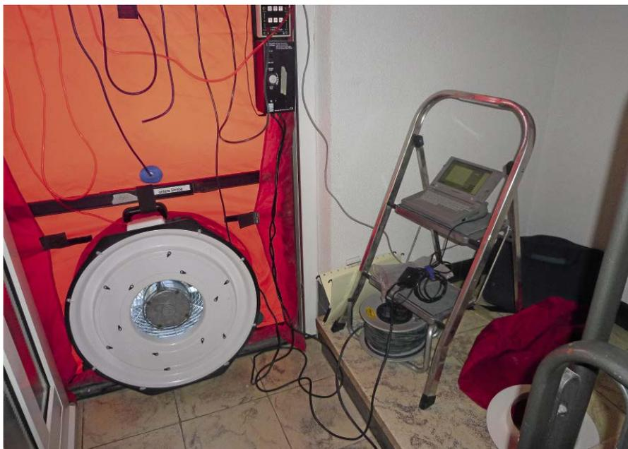
Der luftdichte Foliengerüst samt Ventilator ist das Kernelement des „Blower-Door“-Tests.
