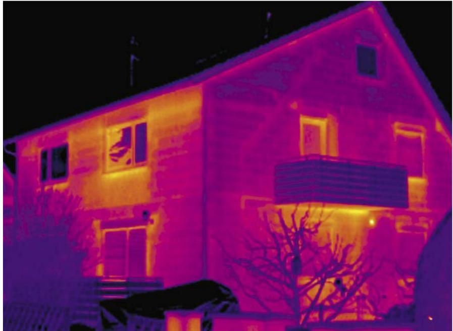
Die Außenthermografie zeigt energetische Schwachpunkte an der Fassade auf.
