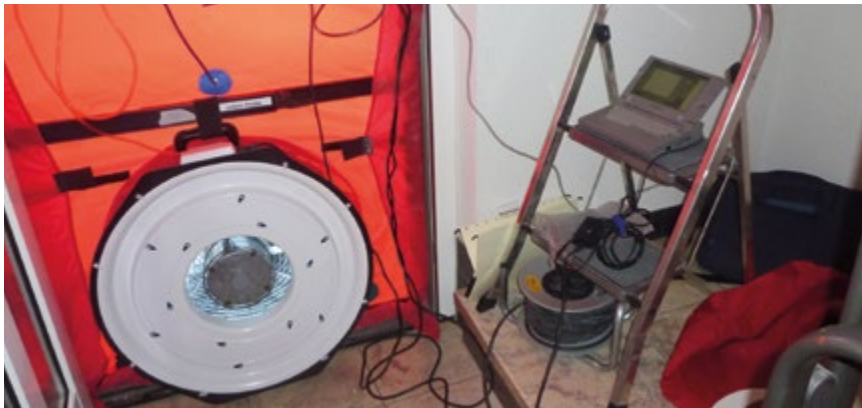
Der Blower-Door-Messaufbau besteht aus einem Folienrahmen mit integriertem Ventilator. Messfühler und Computer gehören zum Messaufbau. © Ludwigsburger Energieagentur LEA e.V.
